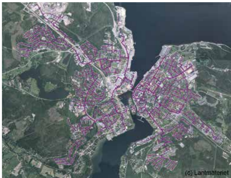
De lila strecken markerar fjärrvärmens utbredning i Härnösand i dagsläget. Fjärrvärmen bidrar till ett mer energieffektivt samhälle genom att ta tillvara energi som annars skulle gå förlorad, till exempel rester från skogsindustrin.
