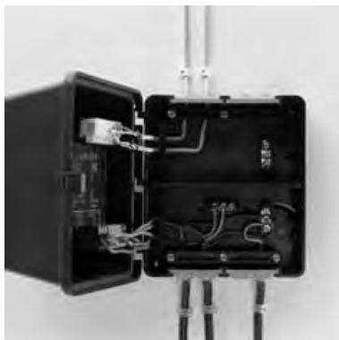
Fig. 3 Montera reglercentralen med bottenplattan. Ledningar drages genom kabelgenomföringar och fästes med dragavlastare mot bottenplattan. Placera ledningarna under kabelhållarna för respektive ledningsgrupp.
